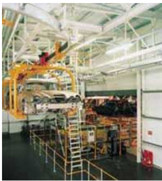
Figur 6.11. Exempel på hängconveyer i bilindustrin. Bild: Swisslog 92 .
