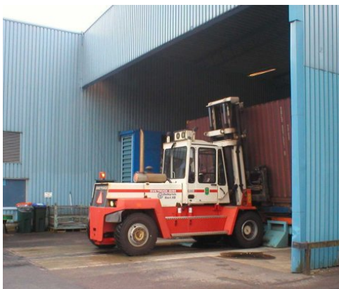
Figur 4.1. Containertruck i arbete utanför den automatiska containerlastaren.
